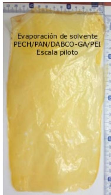
**Figura 2.** Imágenes de las AEM, PECH/PAN/DABCO y PECH/PAN/DABCO-GA/PEI, sintetizadas a escala laboratorio y piloto.
