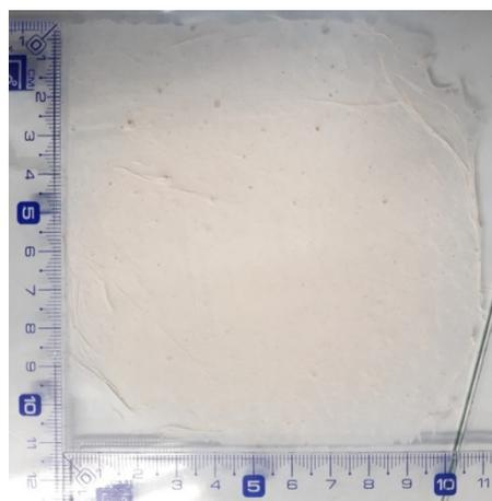
**Figura 3.** Membrana de intercambio catiónico con aditivo (PVC:SDS en relación 1.5:0.4 (m/m)).
