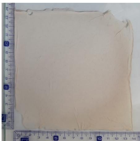
**Figura 2.** Membrana de intercambio catiónico sin aditivo (SDS).
